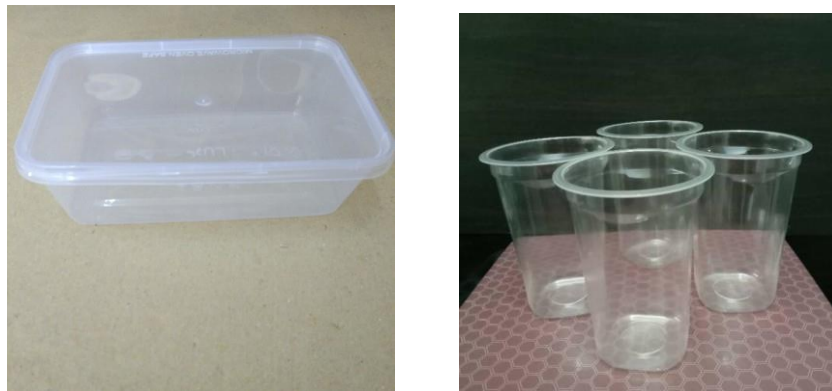
Gambar 15. Wadah SBF digunakan untuk pengujian aliran laminar dan celup total.
