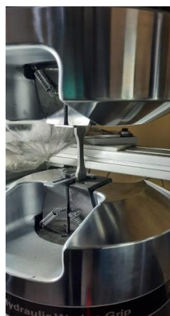
Gambar 23. Pengujian tarik spesimen magnesium AZ31B
