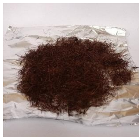
Gambar 3.9 Hasil Polimerisasi Serat Kelapa
