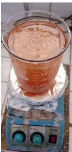
Gambar 3.8 Pencampuran Serat, HCl, Aniline dan APS
