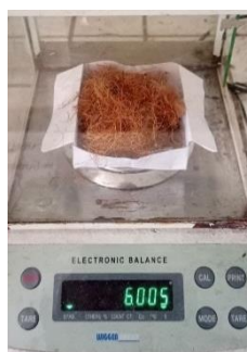
Gambar 3.7 Penimbangan Serat Kelapa
