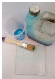
Gambar 3.10 Pelapisan Kaca dengan PVA
