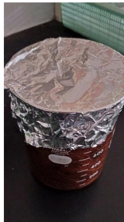
Gambar 3.4 Rendaman Serat Kelapa dengan 2% NaOH
