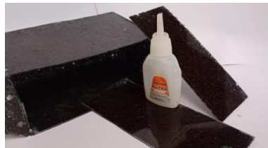
Gambar 3.15 Penyatuan Komposit dengan Lem Cyanoacrylate Adhesive .
