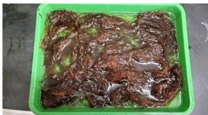
Gambar 3.5 Pencucian Serat Kelapa
