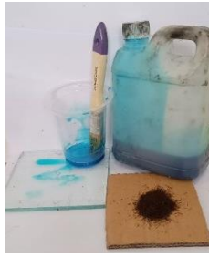
Gambar 3.11 Penaburan Serat Pada Cetakan.
