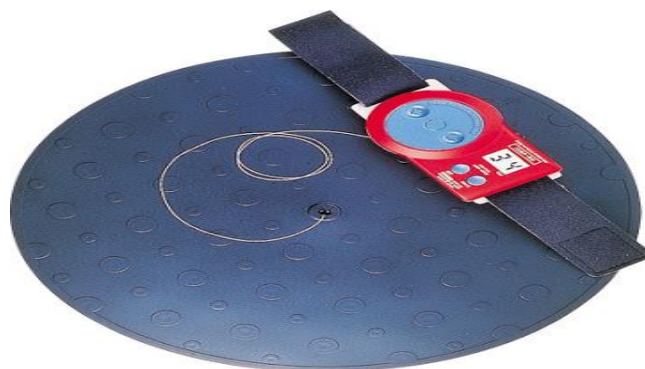
Gambar 3. Alat Jump MD untuk Mengukur Daya Ledak Otot Tungkai
