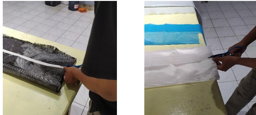
Gambar 3. 3 Pemotongan carbon fiber , peel ply , rilis film , dan breather cloth
