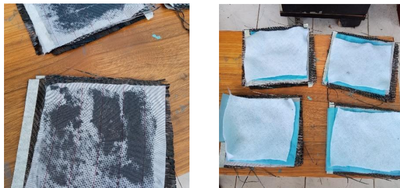
Gambar 3. 6 Pemasangan plastik rilis film, peel ply , dan breather cloth
