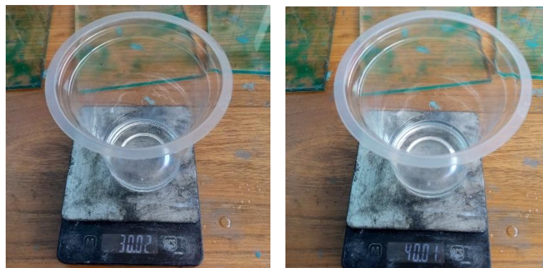
Gambar 3. 4 Ukuran resin dan pengeras yang dicampurkan untuk 5 spesimen
