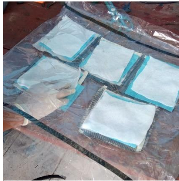
Gambar 3. 7 Proses pemasangan plastik vakum
