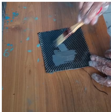
Gambar 3. 13 Pelapisan serbuk logam dengan CFRP
