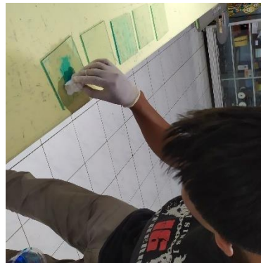
Gambar 3. 2 Pelumasan cairan PVA pada cetakan
