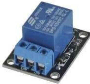
Gambar 2.5 Bentuk Rele Satu *Channel*
