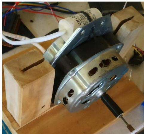
Gambar 3.8 Motor Induksi Kapasitor *Running*
