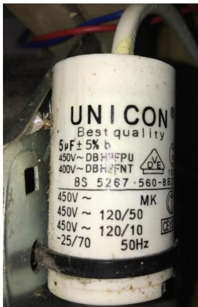
Gambar 3.9 Rating Kapasitor Motor Induksi
