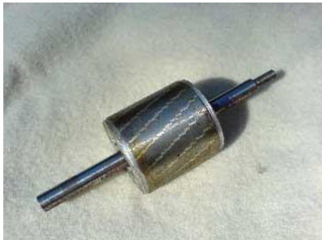
Gambar 2.3 Motor induksi rotor sangkar [1]
