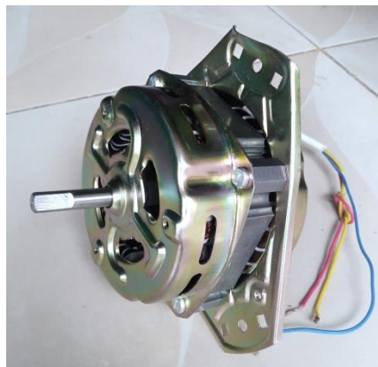
Gambar 3.3 Motor Induksi yang Digunakan pada Penelitian.
