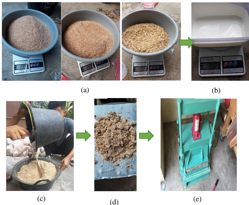
Gambar 14. Proses pembuatan papan agriboard : (a) penimbangan partikel batang singkong, serbuk sengon, dan sekam padi (b) penimbangan perekat LKA, (c) blending bahan baku dan perekat, (d) pengempaan panas papan agriboard
