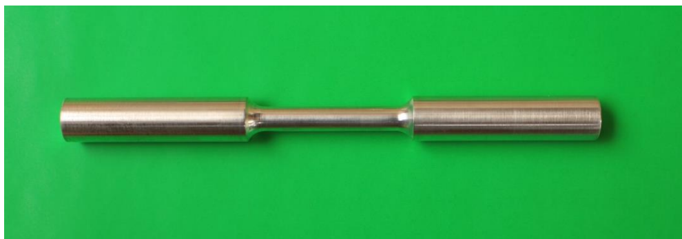
Gambar 3.9 Foto spesimen uji tarik
