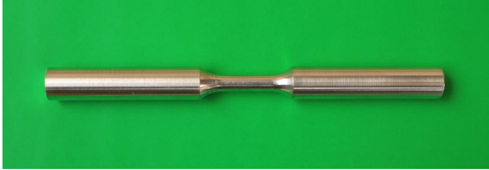
Gambar 3.11 Foto spesimen uji fatik silus rendah
