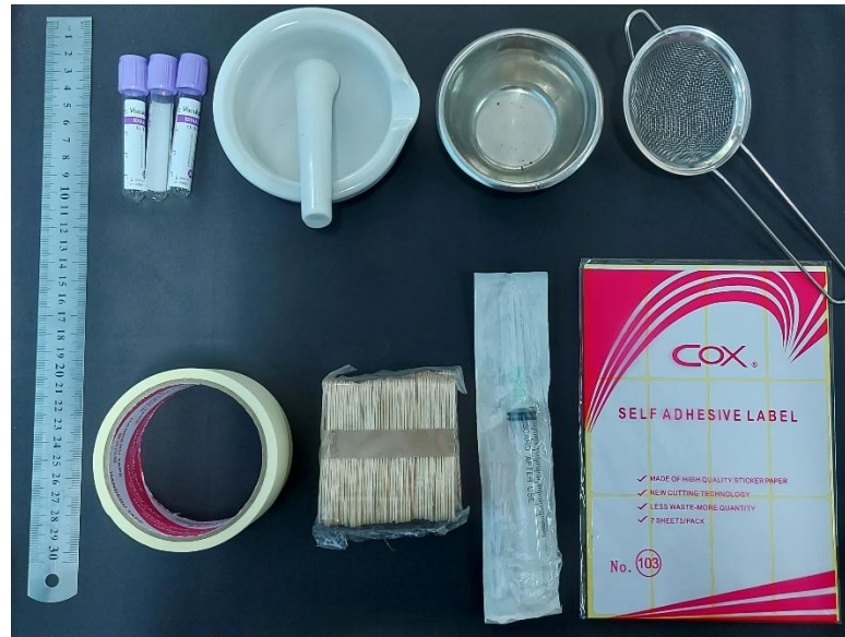
Gambar 12. Peralatan preparasi sampel (Keterangan dari atas kiri: tabung vacutainer non EDTA 5 ml, mortar beserta pestel, mangkuk, saringan, pita perekat, stik kayu, syringe , dan kertas label).
