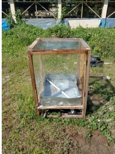
Gambar 1. Alat kondensasi uap air laut penelitian sebelumnya.
