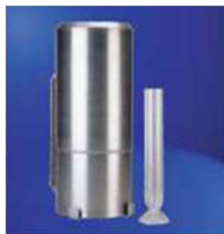
Gambar 2.3 Alat Penakar Hujan Manual Luas Permukaan 200 \text{ cm}^2
