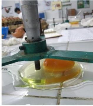
Gambar 10. Pengukuran tinggi *albumen* menggunakan tripod mikrometer
