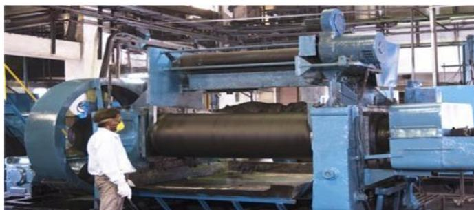
Gambar 2.2. Pencampuran metode otomatis karet alam
