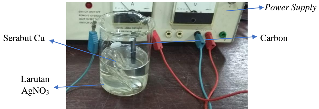
Gambar 3.4. Skema elektroplating pada logam (Hardiyanti dan Santoso, 2018)
