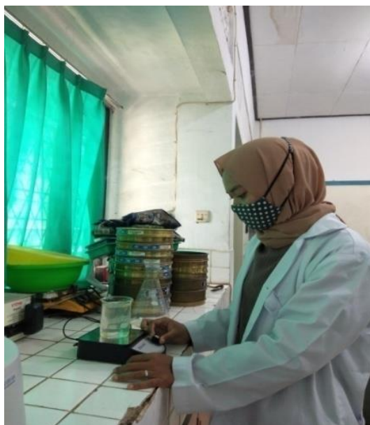
Gambar 6. Proses Pengadukan dengan Magnetic Stirrer .
