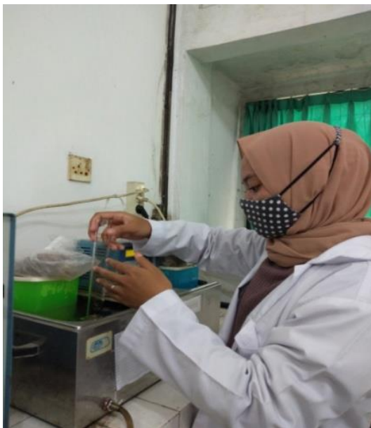
Gambar 3. Proses Pemanasan Madu Menggunakan Waterbath .
