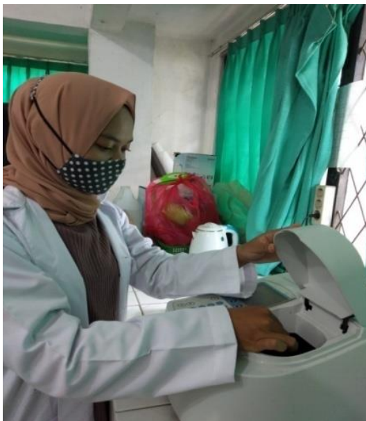
Gambar 9. Proses Pengambilan Spektra Menggunakan UV-Vis Spektroskopi dengan Panjang Gelombang 190-1100 nm.
