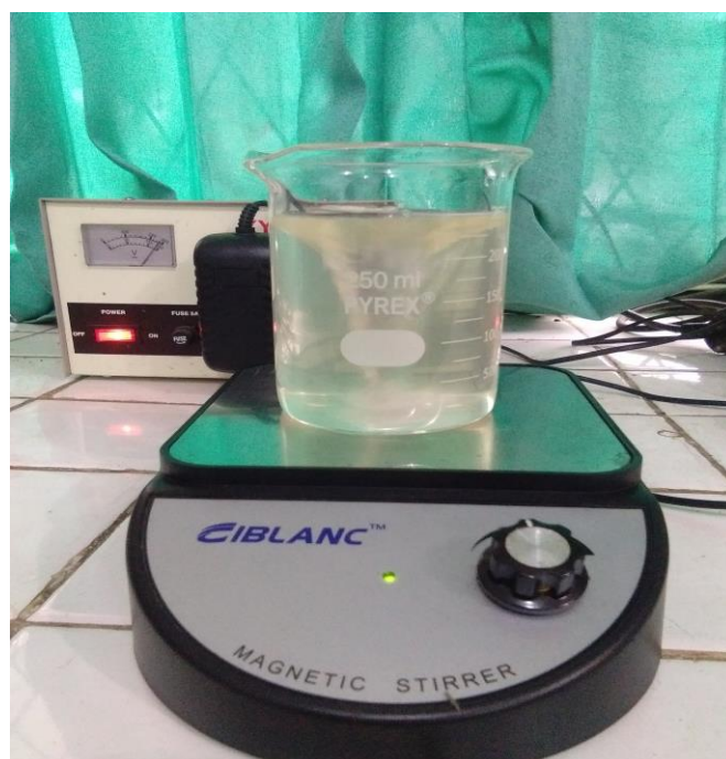
Gambar 10 Pengadukan larutan menggunakan magnetic stirrer CiBlanc .
