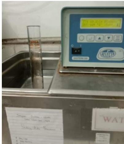
Gambar 8. Proses pemanasan madu menggunakan water bath .
