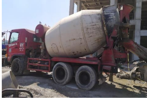
Gambar 3.10. Concrete Mixer Truck Sumber: Dokumentasi Lapangan
