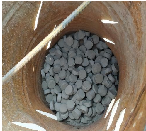
Gambar 3.3. Beton Decking Sumber: Dokumentasi Lapangan
