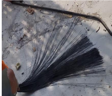
Gambar 3.4. Kawat Bendrat Sumber: Dokumentasi Lapangan
