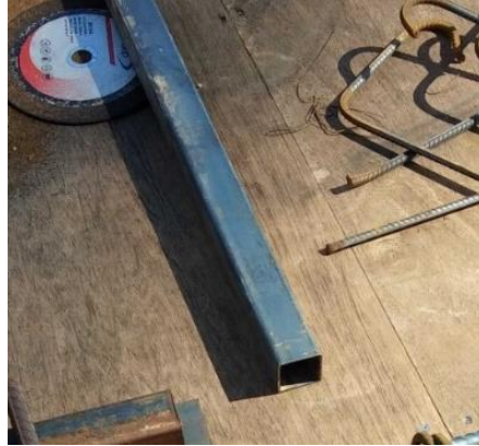
Gambar 3.7. Besi Hollow Sumber: Dokumentasi Lapangan
