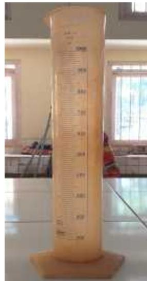
Gambar 10. Gelas silinder kapasitas 1000 cc.
