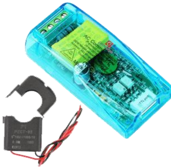
Gambar 2.5 PZEM-004T dengan CT Clamp
