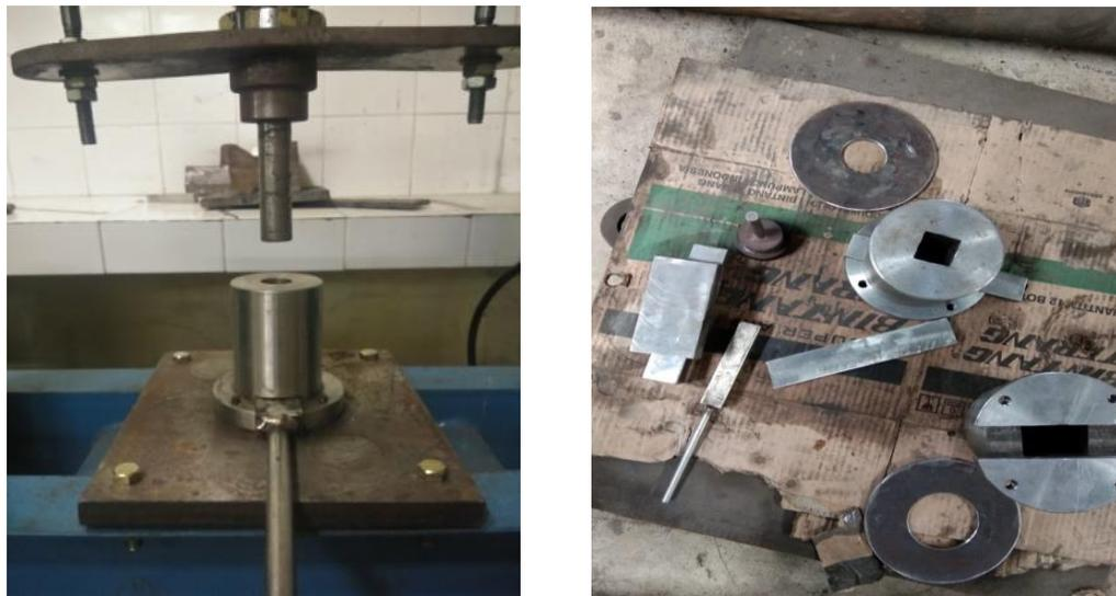
Gambar 29. Alat Kompaksi *Dies dan Punch*
