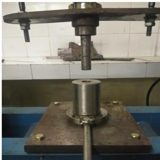
Gambar 34. Perangkat alat kompaksi
