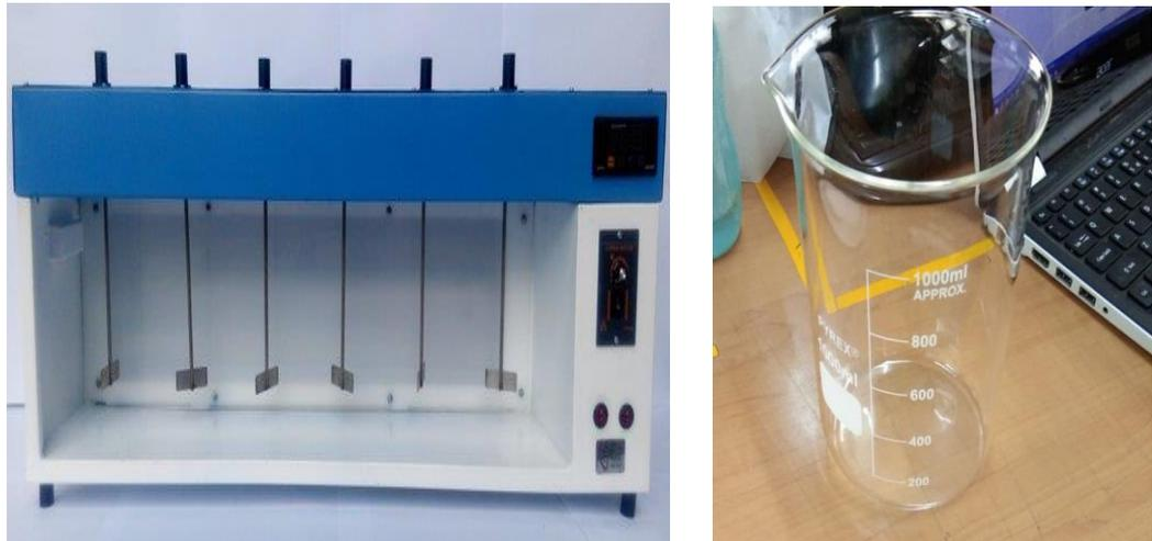
Gambar 26. Mesin *Jar test* dan gelas ukur di PLN UPK Bukit Asam
