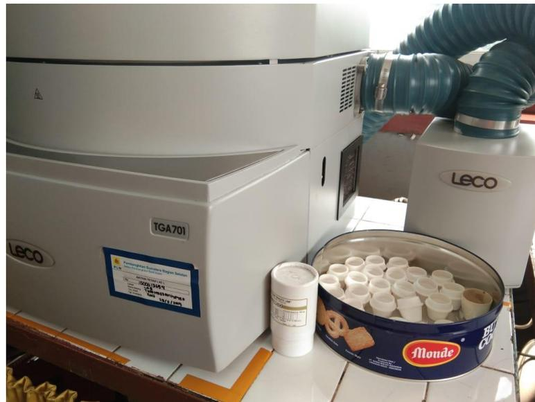
Gambar 36. Alat Uji TGA (*thermo gravimetric analyzer*)Tabel 21. Spesifikasi Alat Uji TGA (*thermo gravimetric analyzer*)
