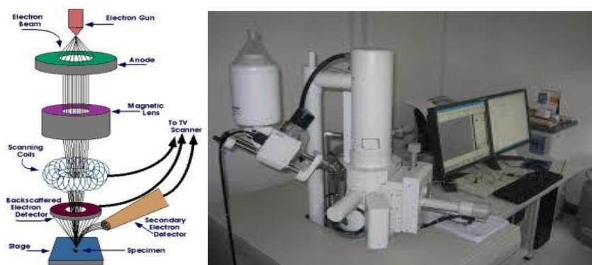
Gambar 17. alat dan proses pengujian SEM
