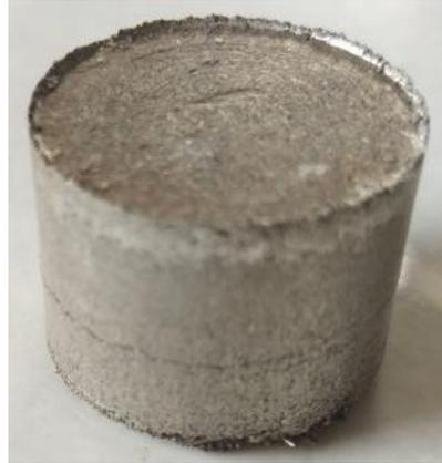
Gambar 35. Spesimen awal kompaksi sebelum di *Oven*
