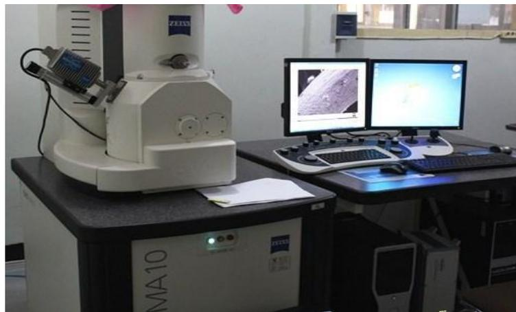
Gambar 41. Alat Uji Struktur Mikro SEM
