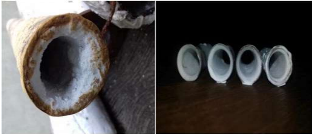
Gambar 1. Endapan kerak pada pipa (Vendamawan, 2016).
