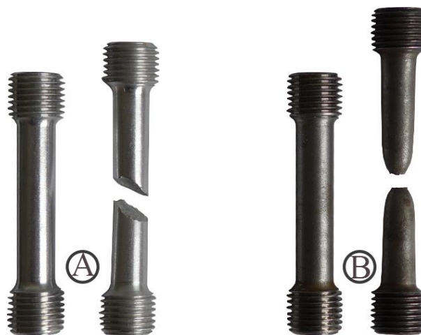
Gambar 4. a) Patah getas b) patah ulet
