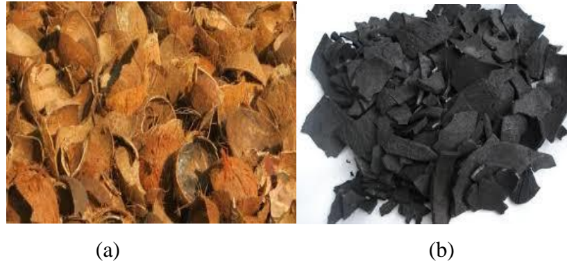
Gambar 4. (a) Tempurung kelapa dan (b). Arang tempurung kelapa).
