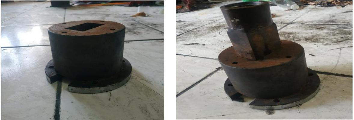
Gambar 3.2. Cetakan spesimen uji.
