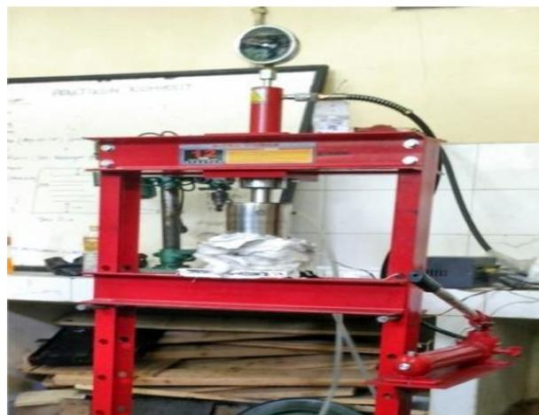
Gambar 3.5. Dongkrak hidrolik
