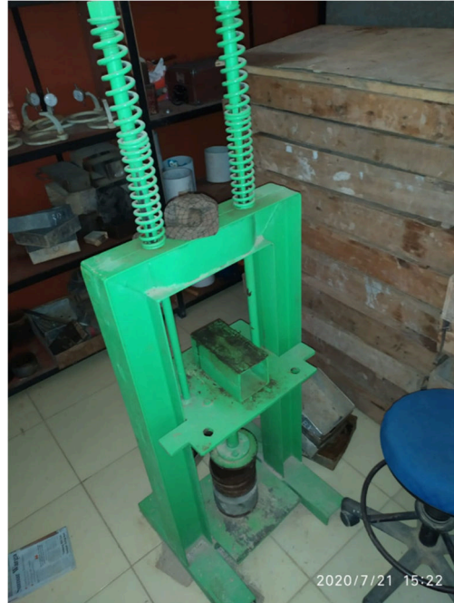
Gambar 6. Alat Tekan Pematik Modifikasi
