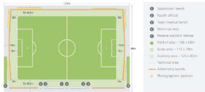
Gambar 2.10. Detail Area Lapangan
