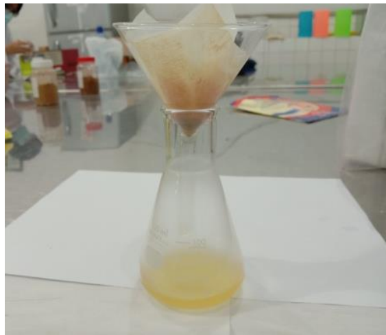
Gambar 11. Proses Penyaringan Sampel Kopi.
