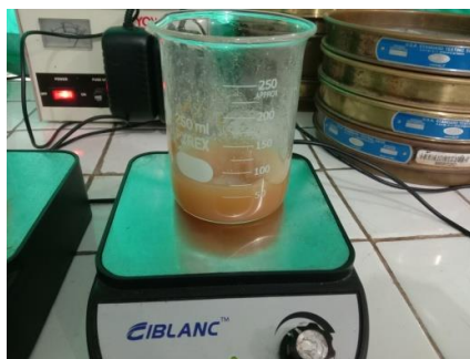
Gambar 10. Proses Pengadukan Sampel Magnetic Stirrer Ciblanc .
