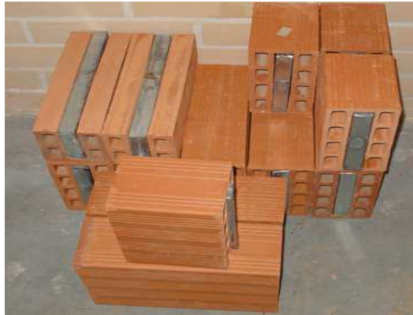
Gambar 2.9 Penggunaan PCM dengan metode enkapsulasi (Soares et al , 2012)
