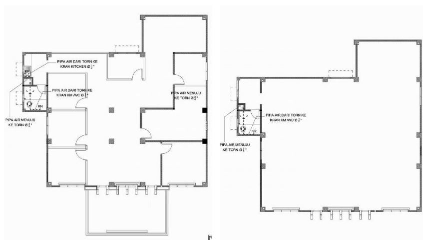
Gambar 3.87 Denah Rencana Air Bersih lantai 2 dan 3
