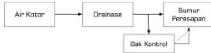
Gambar 5.49 Skema Pembuangan Air Kotor
