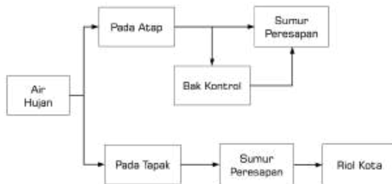
Gambar 5.47 Skema Pembuangan Air Hujan
