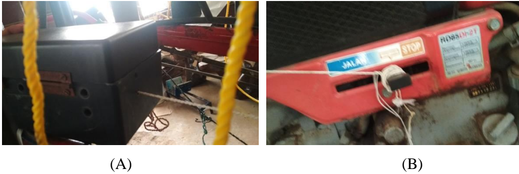
Gambar 3. (A) Kotak actuator , (B) Tuas gas.
