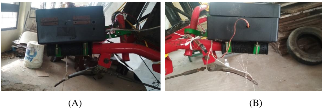
Gambar 4. Kotak actuator pengendali belokan (A) Kanan, (B) Kiri.
