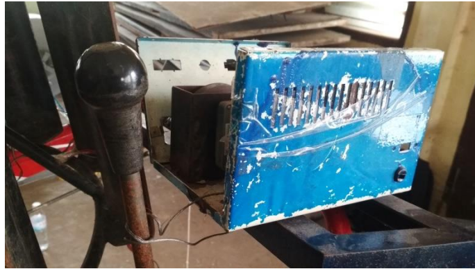
Gambar 5. Kotak actuator pengendali tuas persneling.
