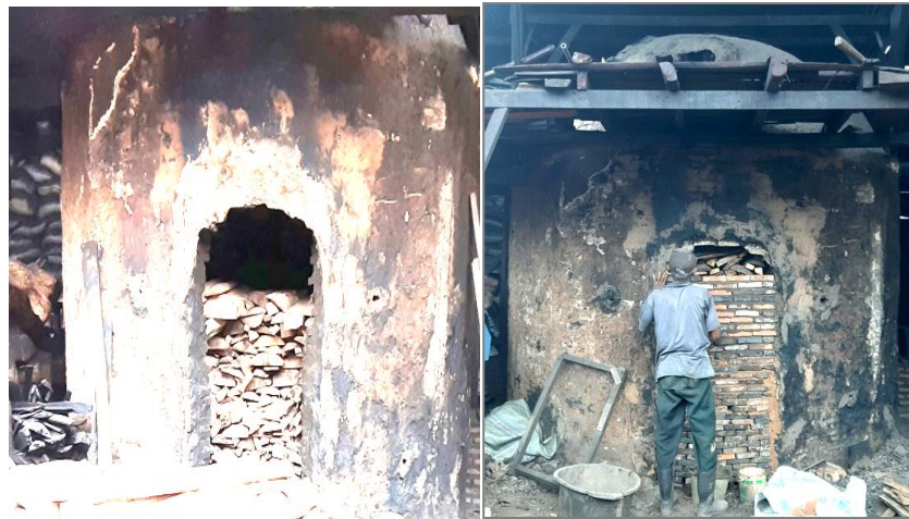
Gambar 2. Tungku kubah pembuatan arang hayati di PT Kendi Arindo Lampung.
