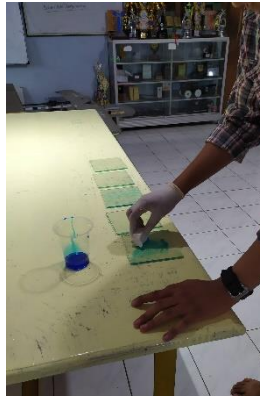
Gambar 3.6. Pelumasan PVA pada cetakan
