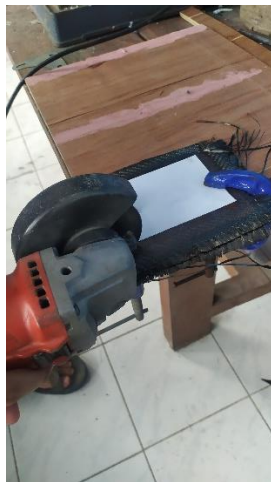
Gambar 3.15. Pemotongan dan penyatuan CFRP dengan lem cyanoacrilate adhesive
