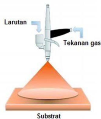
Gambar 2.8. Teknik spray cat konduktif [18].
