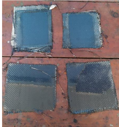
Gambar 3.14. Pelepasan CFRP dari cetakan
