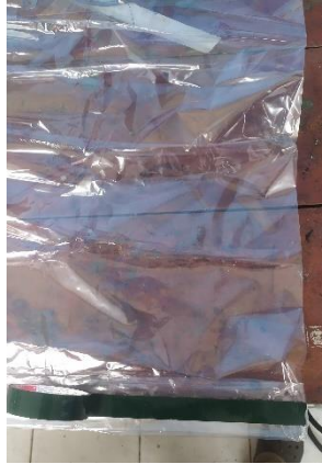
Gambar 3.12. Pemasangan plastik vakum
