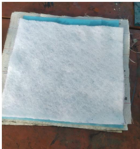
Gambar 3.11. Pemasangan peel ply , plastik rilis film, dan breather cloth
