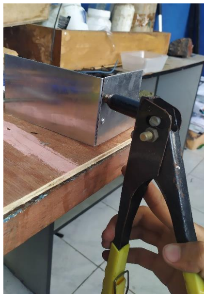
Gambar 3.5. Penyatuan aluminium dengan paku rivet
