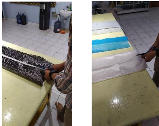
Gambar 3.7. Pemotongan serat karbon, peel ply , plastik rilis film, dan breather cloth
