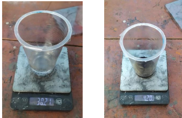
Gambar 3.8. Ukuran resin epoksi dan MWCNTs yang akan dicampurkan
