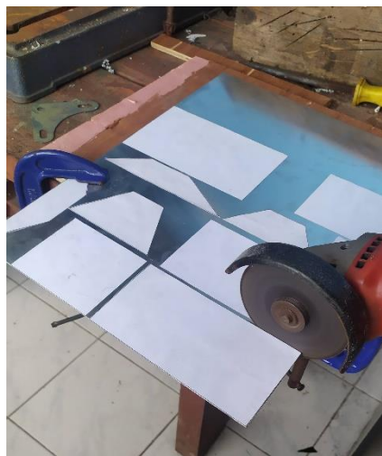
Gambar 3.3. Pemotongan plat aluminium
