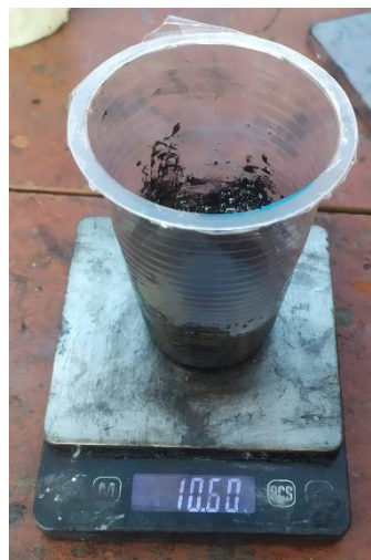
Gambar 3.9. Ukuran pengeras yang dicampurkan
