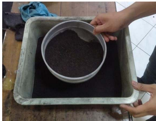
Gambar 28. Mengayak Arang Serbuk Kayu Gergaji dengan Ayakan 100 Mesh .
