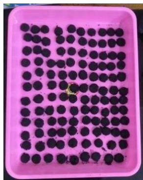
Gambar 30. Pelet Arang Serbuk Kayu Gergaji yang Baru Dicetak.
