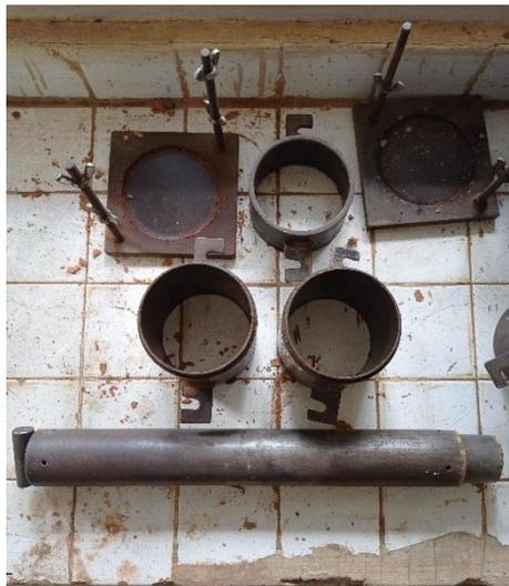
Gambar 2.4. Alat Uji Pemadatan Tanah *Standard Proctor*
