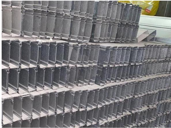
**Gambar 3.31 Rangka baja ringan**
