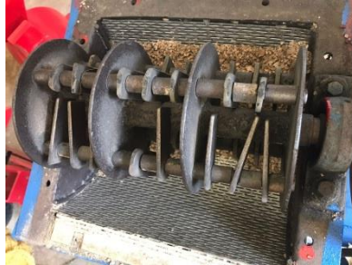
Gambar 4. Ruang penepung hammer mill
