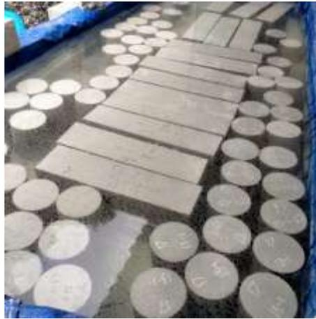
Gambar 3. 4. Perawatan beton.
