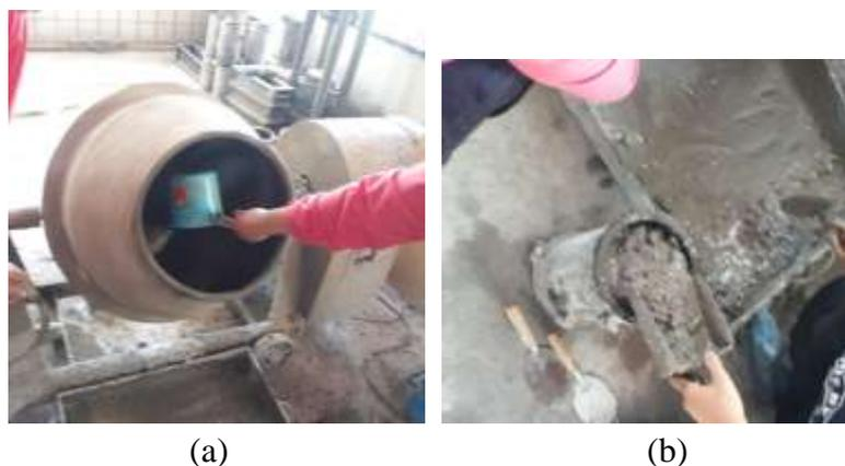
Gambar 3. 2. (a) Pengadukan material, (b) Pencetakan material.
