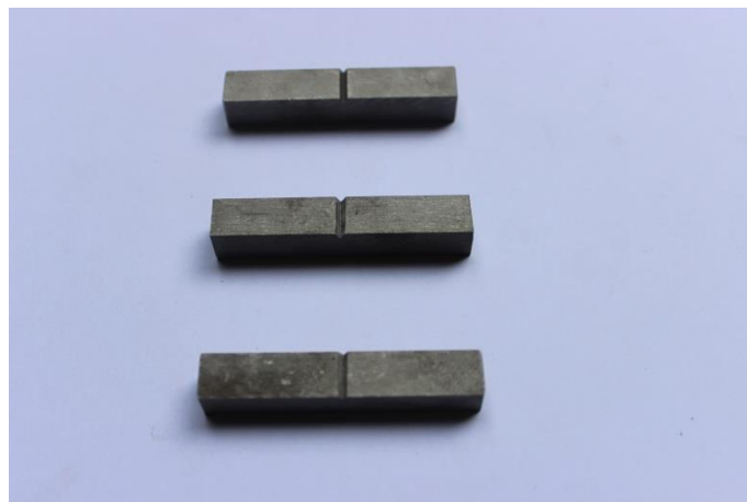
Gambar 3.1 Besi Cor Kelabu FC 25
