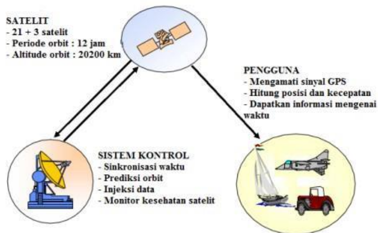
Gambar 1 Sistem Penentuan Posisi Global, GPS ( Abidin , 2007 )
