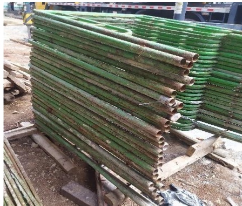
Gambar 3.29 Scaffolding. Sumber : Dokumentasi Penulis.
