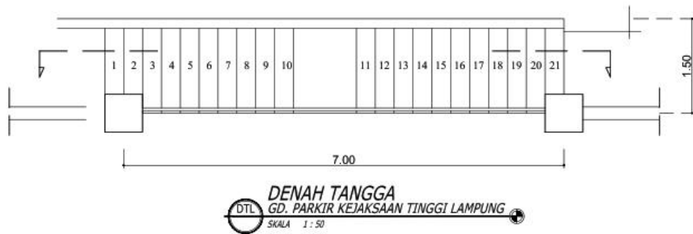
Gambar 3.55 Denah Tangga. Sumber : Gambar Perencanaan Proyek.
