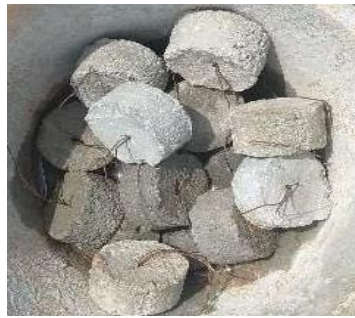
Gambar 3.8 Beton Decking. Sumber : Dokumentasi Penulis.
