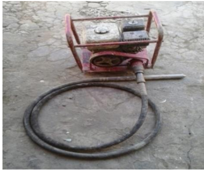
Gambar 3.24 Concrete Vibrator. Sumber : Dokumentasi Penulis.
