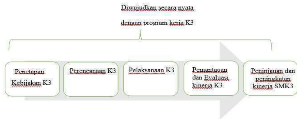
Gambar 4. Keterkaitan Program Kerja K3 Dengan Ruang Lingkup SMK3 Menurut PP 50 Tahun 2012 (Sumber : Buku Pohon Kerja K3)
