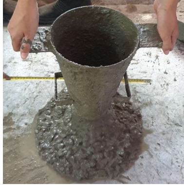
Gambar 9. Pengujian slump flow test .
