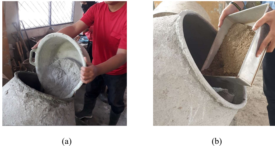
Gambar 8. (a) pengadukan material (b) pencampuran fly ash .
