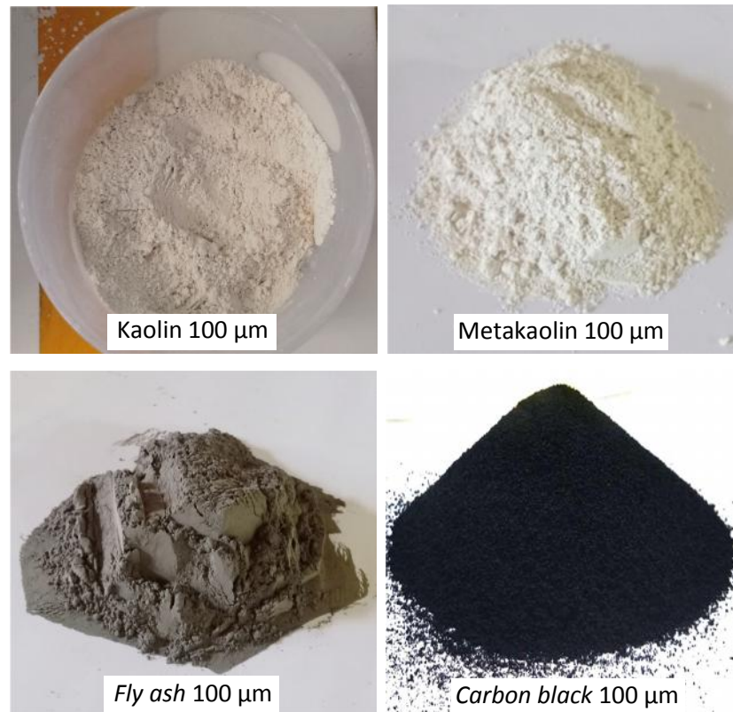
Gambar 16. Serbuk kaolin, metakaolin, fly ash , dan carbon black (CB) 100 \mu\text{m} .
