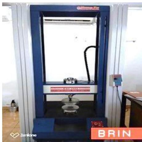
**Gambar 2. 3** Pengujian Kuat Tekan (Sumber: Laboratorium Non-Logam Pusat Riset Teknologi Pertambangan – BRIN)
