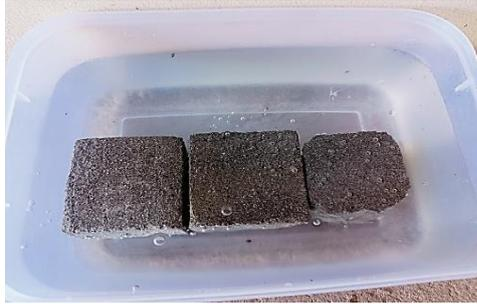
**Gambar 3. 1** Perawatan Mortar dalam Air (*curing*)
