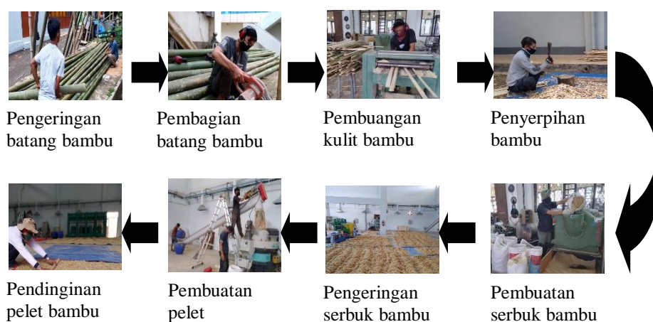
Gambar 3. Diagram alir proses pembuatan pelet bambu andong dan betung
