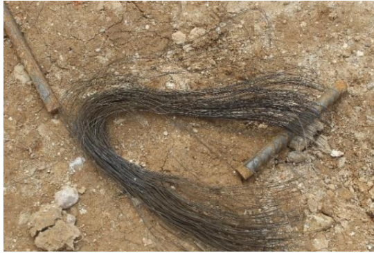
Gambar 3.3 Kawat Bendrat Sumber : Dokumentasi Lapangan
