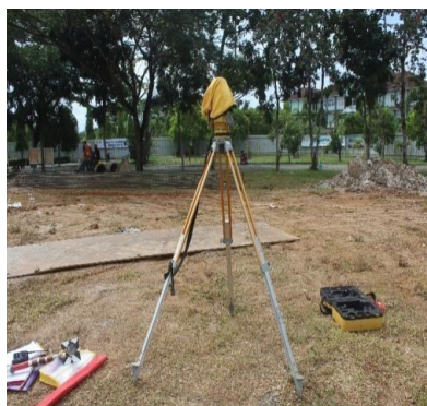
Gambar 3.4 Theodolite Sumber : Dokumentasi Lapangan
