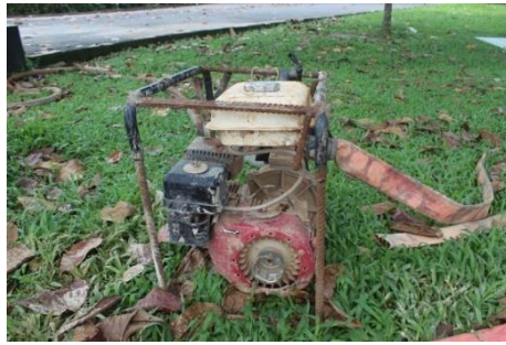
Gambar 3.13 Pompa Air (Alcont) Sumber : Dokumentasi Lapangan
