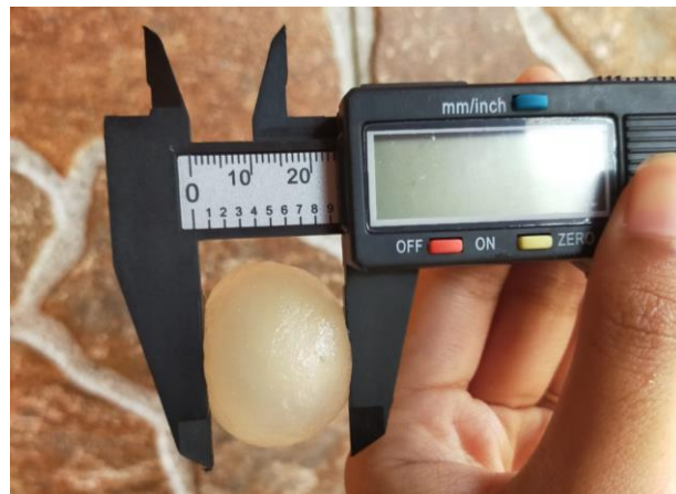
Gambar 8. Proses pengukuran diameter pendek buah rambutan
